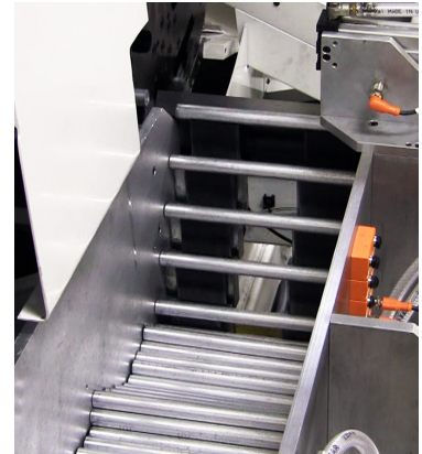
Tolva de Tubo Automatizada
